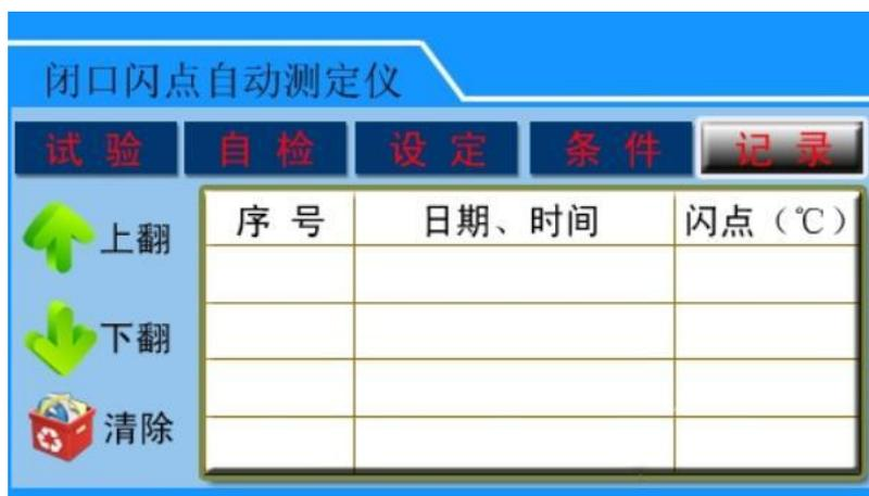
该界面显示已测试样的测定结果试验记录。“上翻”、“下翻”按钮用以翻页查询，“清除”按钮用于清空记录存储区的所有数据记录。一点击“清除”后弹出确认清空记录窗口，避免因误操作而意外删除所有的试验记录。
