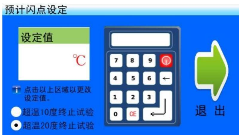
该界面下，点击“设定值”区域，键盘上方预计闪点设定值输入框处光标闪烁，可以输入数字，并按“←|”确认输入。要删除输入的数字，可以点击“←”。点击右上角的“X”，退出预计闪点设定界面。点击左下方“超温 10度终止试验”或“超温 20度终止试验”用于选择符合国标方法(超过设定温度 10度终止测试)或非国标方法（超过设定温度 20度终止测试）的终止测试条件。
