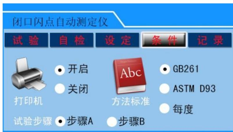
该界面用以设置打印机的开启、关闭及测试试样所符合的标准、采用国标时根据样品分类而采用的不同测试步骤等。采用的标准包括 GB261-2008和 ASTM D93,设定为“每度”时，测试试样开始后，在温度上升约 5℃时，每升高 1度即开盖并点火一次，试验试样是否闪火，适用于并不确知闪点范围的试样。选择“步骤 A”时，按 GB/T261-2008要求的步骤 A测试方法测试样品；选择“步骤 B”时，则按 GB/T261-2008要求的步骤 B测试方法测试样品。
