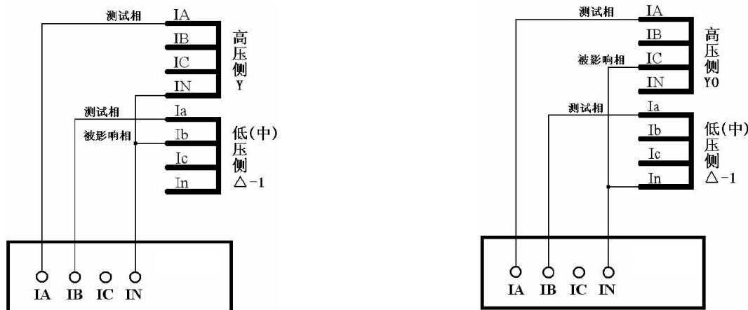
Y 侧相位调整, 无零序修正, 按单相短路接线
