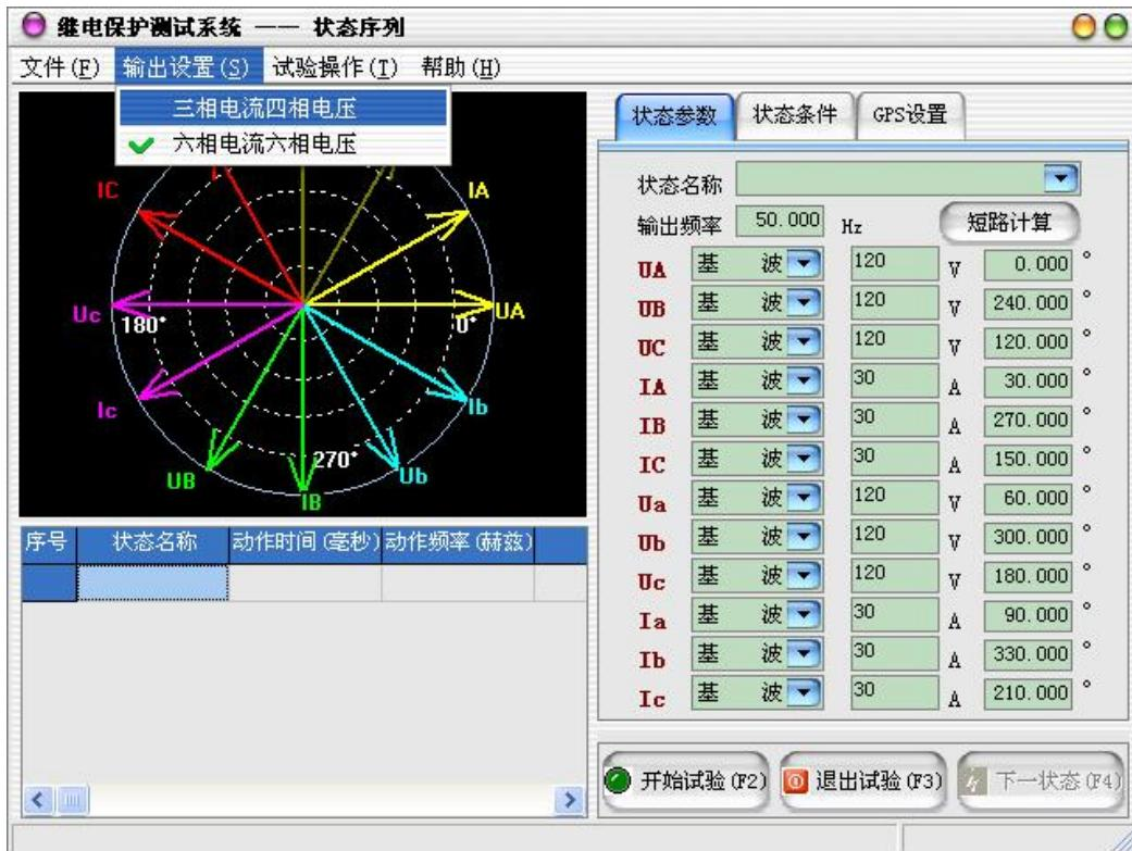
三相电流四相电压的测试仪只能使用“三相电流四相电压”的输出方式，六相电流六相电压的测试仪则既可使用“三相电流四相电压”的输出方式，也可使用“六相电流六相电压”的输出方式。
