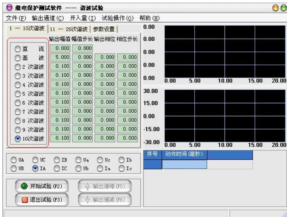
在中部的输入框中设置“输出幅值”、“幅值步长”、“输出相位”、“相位步长”，各电压、
